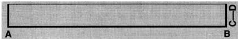
Skizze a: Eine Saite, Mensur A-B 100 mm, Steg- und Sattelhöhe = Saitenlage C-D 10 mm
